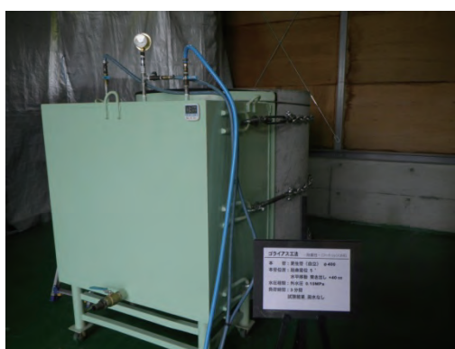
写真4-44 漏水の有無確認
