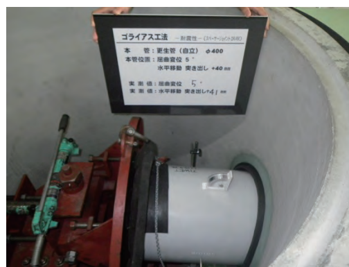
写真4-42 屈曲角 5^{\circ} かつ 突出し 40 mm 確認
