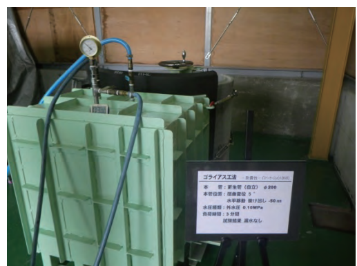
写真 4 - 40 漏水の有無確認
