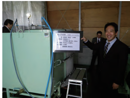
写真4-48 漏水の有無確認
