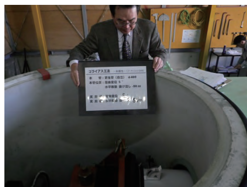
写真4-46 屈曲角 5^{\circ} かつ 拔出し 50 mm 確認
