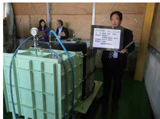
写真 4 - 36 漏水の有無確認
