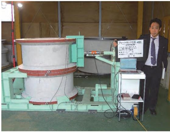
写真 4-16 耐震性試験状況（荷重方向：プレート取り付け部）
