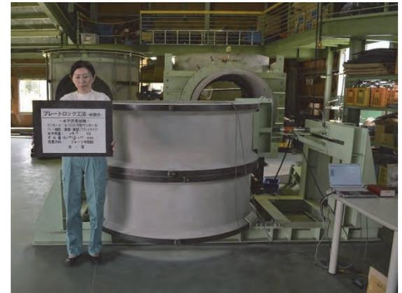
写真 4 - 21 耐震性試験状況（荷重方向：プレート中間部，水平力23.9 kN以上）
