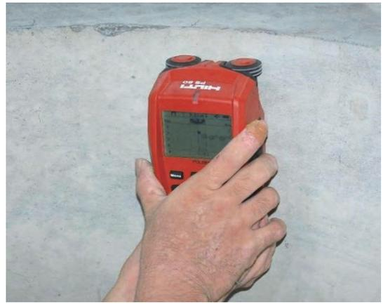
写真 4 - 8 鉄筋探査状況
