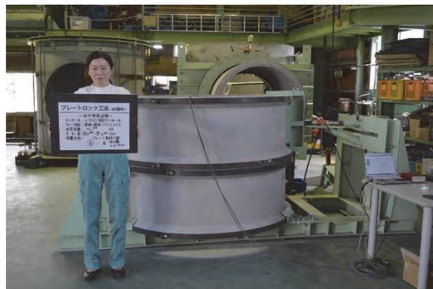
写真 4 - 22 耐震性試験状況（荷重方向：プレート取り付け部，水平力42.3 kN以上）
