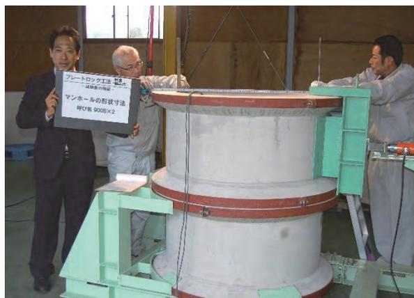
写真4－15 マンホール側塊の形状寸法確認状況
