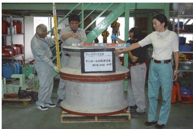
写真 4－23 マンホール側塊の形状寸法確認状況
