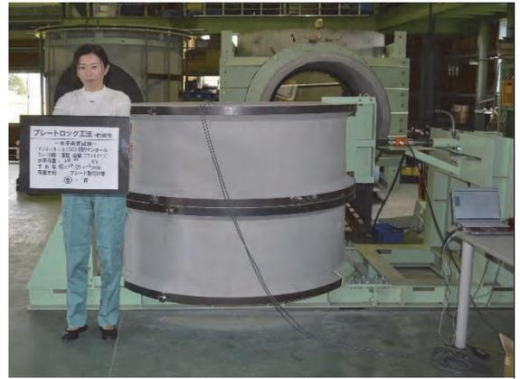
写真 4 - 20 耐震性試験状況（荷重方向：プレート取り付け部，水平力23.9 kN以上）
