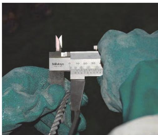
写真4-6 コンクリートドリル，ドリルビット確認状況
