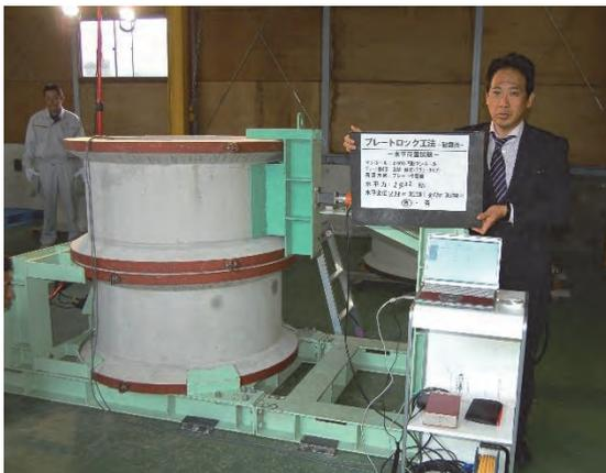
写真 4-17 耐震性試験状況（荷重方向：プレート中間部）
