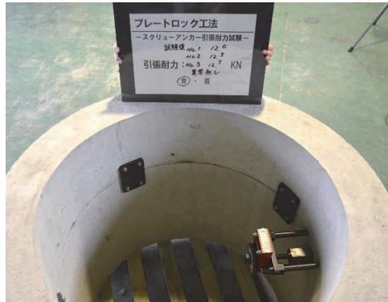
写真 4 - 13 スクリューアンカー引張耐力の確認
