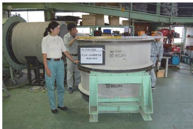
写真 4－19 マンホール側塊の形状寸法確認状況
