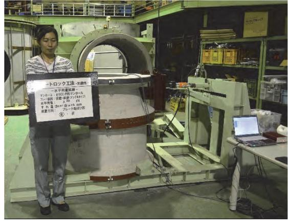
写真 4 - 24 耐震性試験状況（荷重方向：プレート取り付け部）
