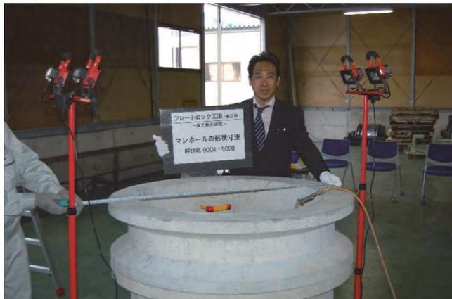
写真4-4 内径900 mmマンホール形状寸法確認状況
