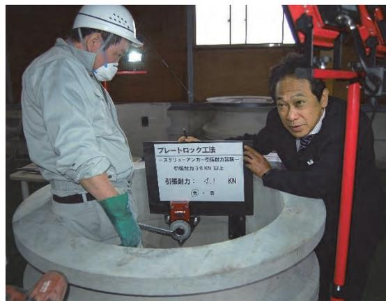
写真 4 - 12 スクリューアンカー引張耐力の確認
