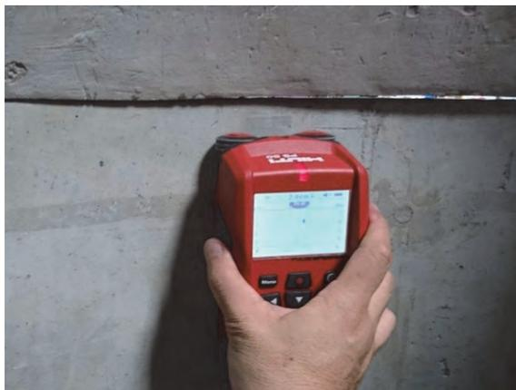
写真1-9 鉄筋探査状況
