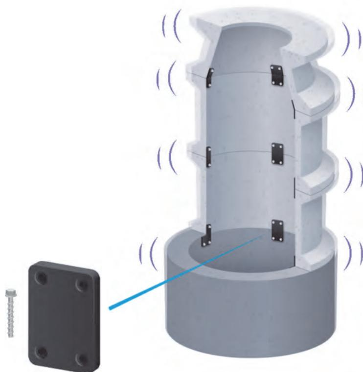
図1-1 プレートロック工法の概要
