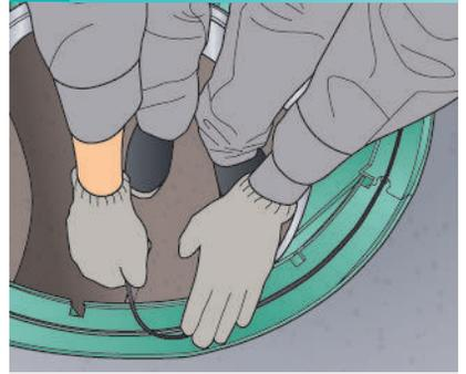
樹脂セグメントの上面の溝に沿ってシール材をセットします。
